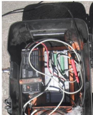
Piranómetro + datalogger, mediciones cada segundo
