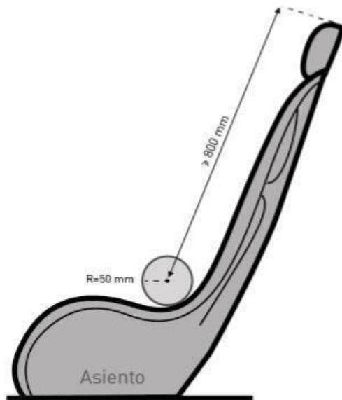
La disposición del asiento del vehículo debe ser tal, que, en posición de conducción, los talones del ocupante se ubiquen bajo el extremo inferior de la base del asiento. Además, el ángulo formado entre sus hombros, caderas y rodillas debe exceder los 90°.
